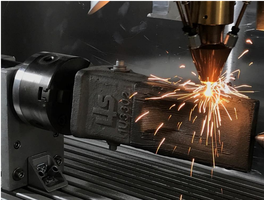
Bild 2: Das LMD-Verfahren ist ein Teilbereich des 3D-Metalldrucks, Bildquelle: S-UBG
