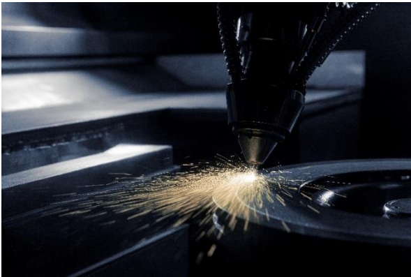
Bild 1: Das WECODUR®-Beschichtungsverfahren ermöglicht eine wirtschaftlichere Serienbeschichtung von beispielsweise Bremsscheiben. Quelle: HPL Technologies
