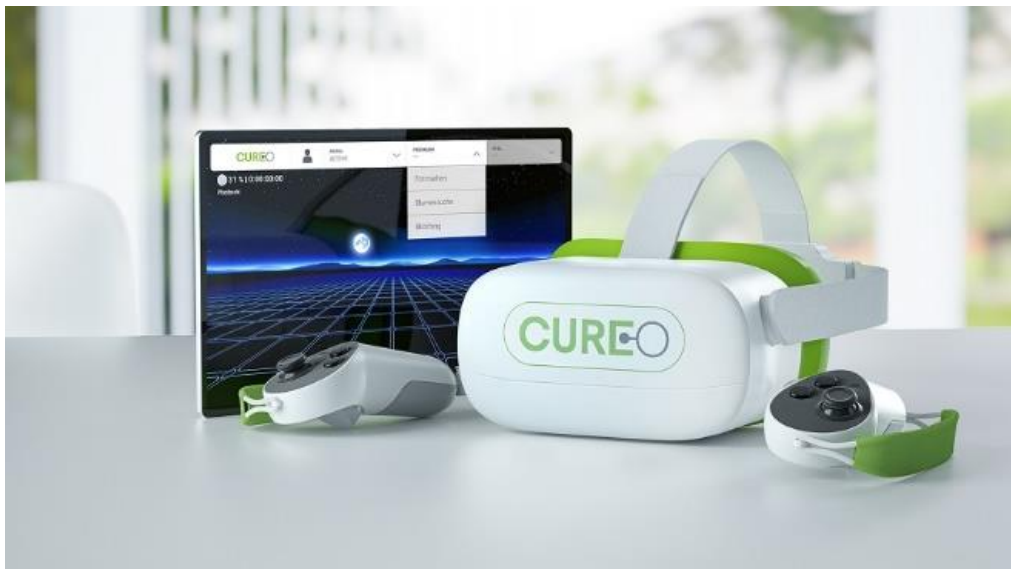
Bild 1: Das System CUREO besteht aus einer VR-Brille, Handcontrollern und einem Tablet-PC. Quelle: CUREosity
