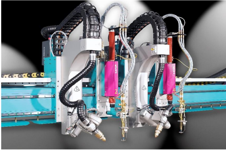
Bild 2: SATO-Fasenaggregat mit Autogen- und Plasmaschneidtechnik, Bildquelle SATO GmbH.
