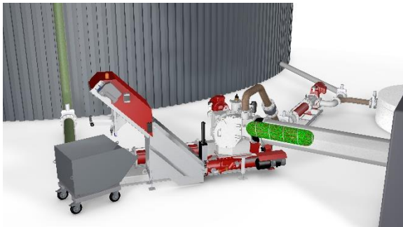
Bild 3: PreMix mit Debris Removal System und Debris Lift Unit für ein effizientes Fremdkörperhandling.
