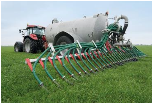
Bild 3: Das kompakte UniSpread-Gestänge ist mit verschiedenen Gülleauslässen kombinierbar (hier: Schleppschuh).
