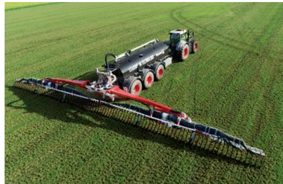
Bild 4: Das BlackBird-Schleppschuhgestänge mit 24 Metern Arbeitsbreite platziert die Gülle präzise an der Pflanze.
