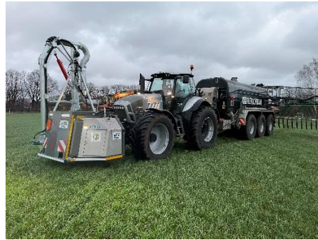
Bild 2: Das Güllestabilisierungssystem SyreN mit Frontsaugarm für eine emissionsarme und effiziente Ausbringung.
