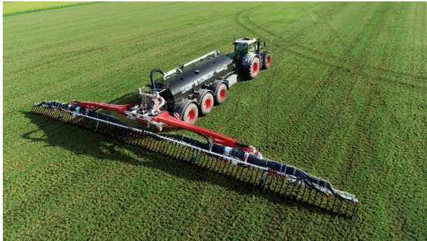
Bild 1: Auf der Agritechnica stellt Vogelsang das Schleppschuhgestänge BlackBird (hier noch in einer Arbeitsbreite von 24 Metern) erstmals in einer Arbeitsbreite von 30 Metern vor.
