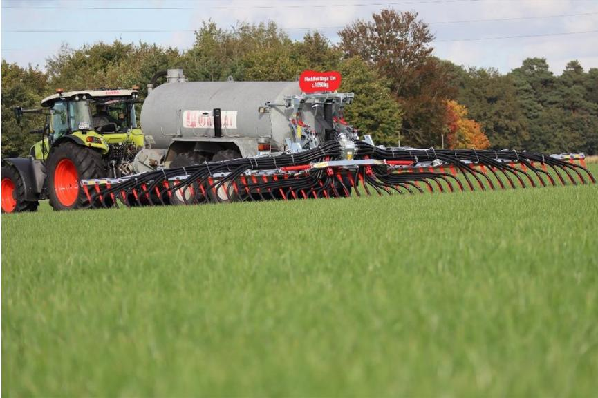
**Bild:** BlackBird Single von Vogelsang, hier mit 12 Metern Arbeitsbreite: schlankes Schleppschuhgestänge für die einfache Nachrüstung.
