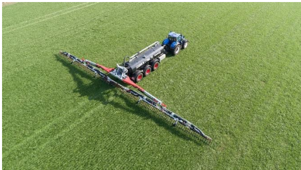
Bild 1: Premiere auf der Agritechnica: das Vogelsang-Schleppschuhgestänge BlackBird in einer Arbeitsbreite von 30 Metern.
