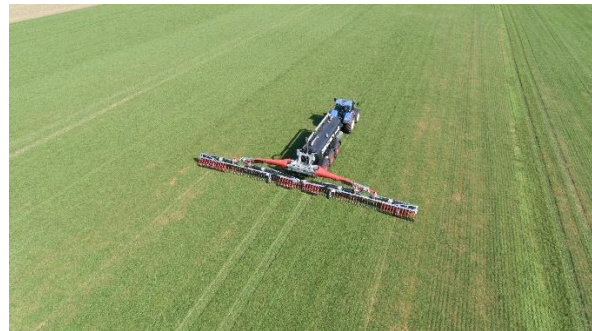
Bild 2: Der große BlackBird, hier geklappt auf eine Arbeitsbreite von 21 Metern. Insgesamt bietet das flexible Gestänge Arbeitsbreiten von 30, 27, 24 und 21 Metern ohne jeglichen Überstand zur gewählten Arbeitsbreite.
