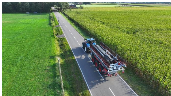
Bild 4: Mit einer Armlänge von 9 Metern in Transportstellung (gemessen ab Unterlenker) lässt sich der neue große BlackBird an eine Vielzahl von Güllefässern anbauen.
