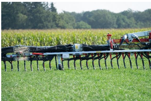
Bild 3: Der Exaktverteiler ExaCut ECM kommt ohne Lufnachsaugung aus und ist viermal im BlackBird 30 Meter verbaut.
