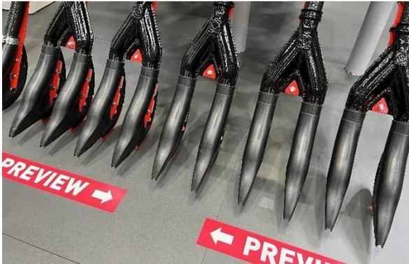
**Bild 1:** Prototyp der Doppelkufe „DoubleFlow“ auf der Agritechnica: Ein Y-Stück teilt den Ablaufschlauch auf zwei Abgänge.
