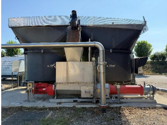
Bild 1: Der kompakte Feststoffdosierer MixXPump ist besonders für die Aufbereitung von einfachen Inputstoffen wie Silage aus Biomasse geeignet.
