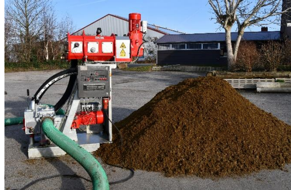
Bild 4: Der Separator XSplitt Compact trennt die Gülle zuverlässig in eine feste und eine flüssige Phase.
