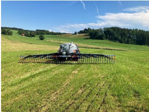
Bild 1: Mit dem BlackBird-Schleppschuhgestänge von Vogelsang legen Landwirte und Lohnunternehmen die Gülle emissionsarm in schmalen Streifen ab.
