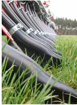
Bild 2: Die Kufe teilt den Pflanzenbestand, dringt in den Boden ein und platziert die Gülle über die PrecisionFlow-Tülle wurzelnah an der Pflanze.
