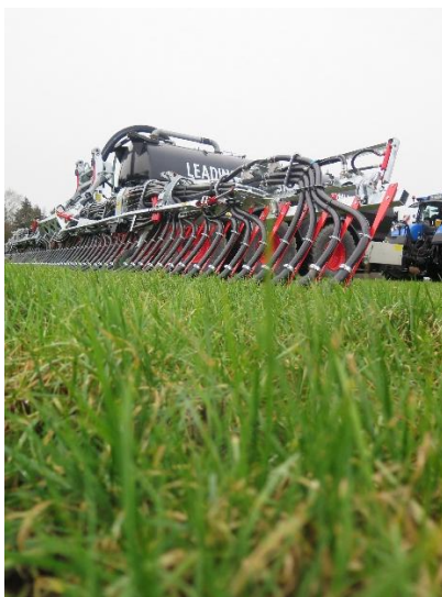
Bild 3: Die wurzelnaher Gülleablage sorgt für gesundes Pflanzenwachstum und hohe Futterqualität.
