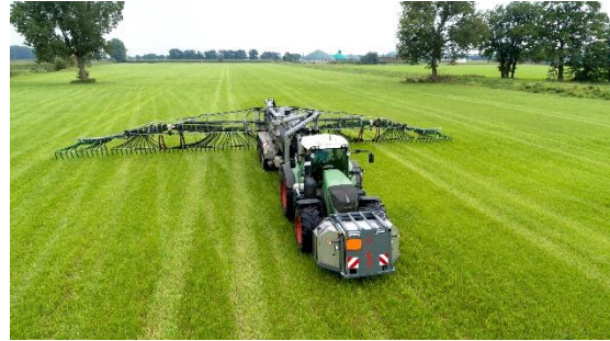
Bild 2: Die Güllestabilisierung mit SyreN von Vogelsang reduziert Ammoniakemissionen um bis zu 70 Prozent.
