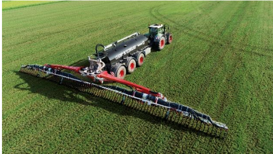
Bild 1: Das Schleppschuhgestänge BlackBird platziert die Gülle präzise und emissionsarm auf bis zu 24 Metern Arbeitsbreite.
