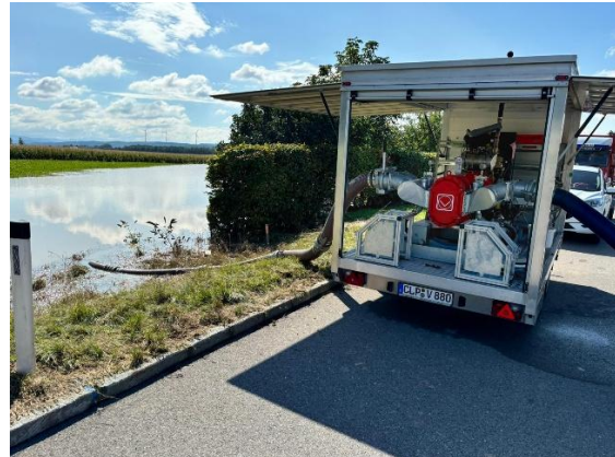
Bild 2: Mobile Pumpeneinheiten für die Hochwasserbekämpfung.
