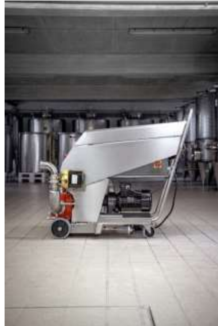
Bild 2: Das Fahrgestell ist für eine leichtere Handhabung jetzt mit vier statt drei Rädern ausgestattet.
