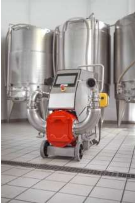
Bild 1: Die Weinpumpe mit integrierter VY-Pumpe eignet sich für alle wichtigen Prozesse der Weinerstellung.
