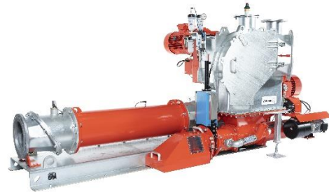
Bild 2: Der PreMix ist eine Kombination aus der HiCone und dem RotaCut RCX mit einer neuen Variante der ACCplus Messernachstellung.
