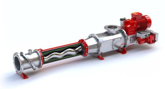
Bild 3: Einzigartige Geometrie: Die HiCone zeichnet sich durch die konische Form von Rotor und Stator aus.
