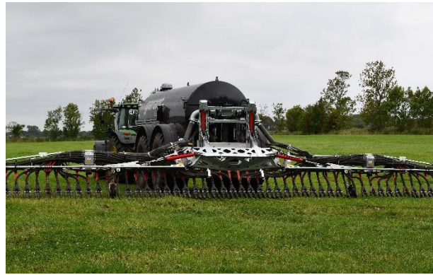
Bild 2: Die Schleppschuhgestänge der BlackBird-Serie (hier: BlackBird Pro) legen die Gülle präzise, wurzelnah und gleichmäßig ab.
