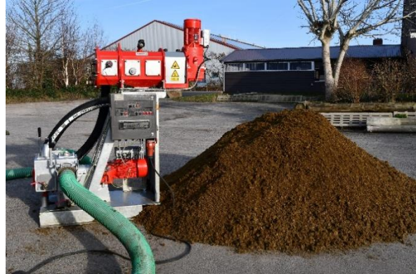
Bild 4: Mit dem XSplit Compact können landwirtschaftliche Betriebe das Lagervolumen um bis zu 25 Prozent reduzieren.
