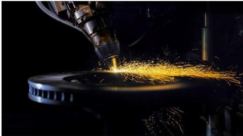
**Bild 1:** Mit dem Laser-Cladding-Verfahren WECODUR® können Automobilhersteller die Euro-7-Norm einhalten.
