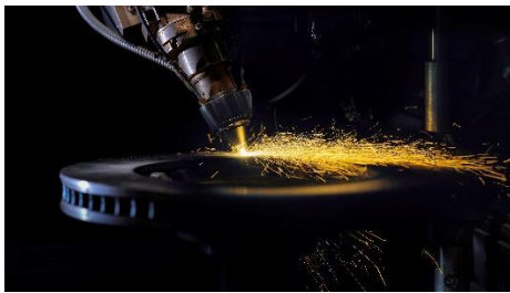
Bild 2: Laser-Cladding-Technologie für umweltschonende Bremscheiben. Quelle: HPL Technologies GmbH
