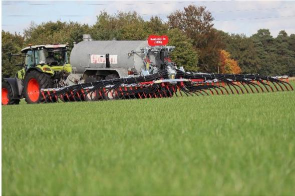
**Bild 1:** Mit dem Schleppschuhgestänge BlackBird Single legen Anwender die Gülle emissionsarm und wurzelnah ab.
