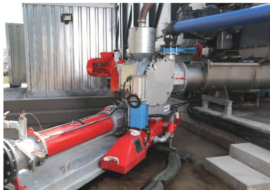
Bild 4: Das Flüssigfütterungssystem PreMix mit Debris Removal System im Einsatz: Es vereint vier Arbeitsschritte in einer kompakten Einheit und ermöglicht gesteigerte Gaserträge bei gleichzeitig reduziertem Eigenenergiebedarf – auch bei anspruchsvollen Feststoffen und variierenden Rahmenbedingungen.
