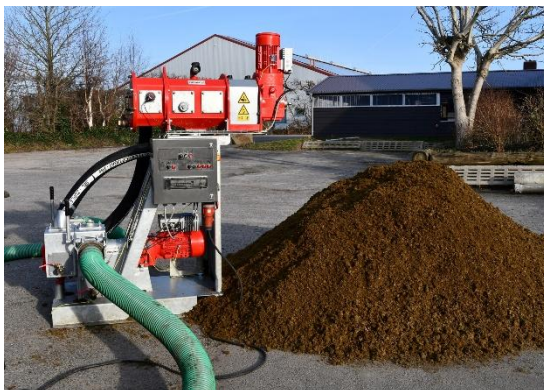
Bild 3: Besonders fließfähig wird die Gülle durch die Fest-Flüssig-Trennung mit der kompakten Separatoreinheit XSplit Compact von Vogelsang.
