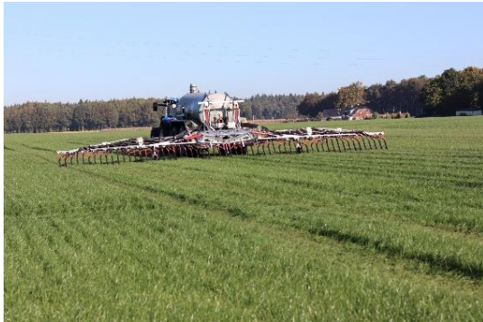
Bild 1: Das Schleppschuhgestänge BlackBird Light, hier in einer Arbeitsbreite von 15 Metern, ist kompakt gebaut und lässt sich einfach nachrüsten.
