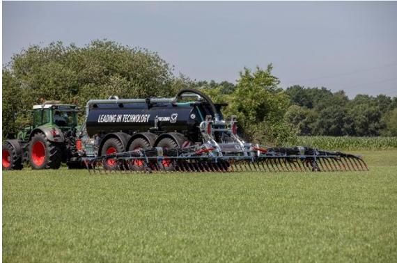
**Bild 1:** Präzise Gülleausbringung mit dem Schleppschuhgestänge BlackBird, hier auf einer Arbeitsbreite von 15 Metern.
