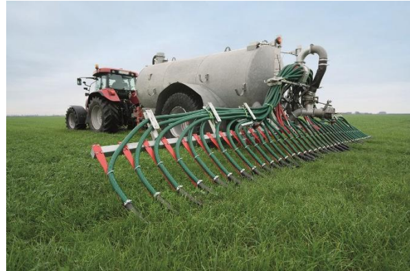
Bild 2: Das Universalgestänge UniSpread, hier in einer Arbeitsbreite von 10,5 Metern, lässt sich einfach nachrüsten.
