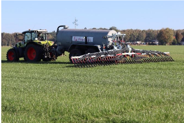
Bild 1: Mit dem Schleppschuhgestänge BlackBird Single, hier in einer Arbeitsbreite von 12 Metern, bringen Landwirte die Gülle emissionsarm und wurzelnah aus.
